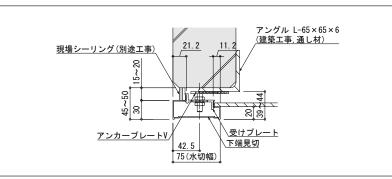
アングル L-65×65×6 <u>(建築工事,通し材)</u> 現場シーリング <u>(別途工事)</u> 現場シーリング <u>(別途工事)</u> 21. 2 11.2 45~50 30 22 受けプレ-下端見切 65 65 120(水切幅) 120(水切幅) S=1/6
