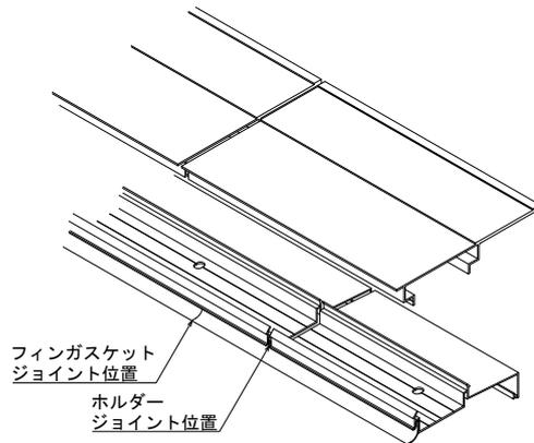
※ホルダージョイント位置とフィンガスケットジョイント位置は、雨仕舞のためずらしてください
