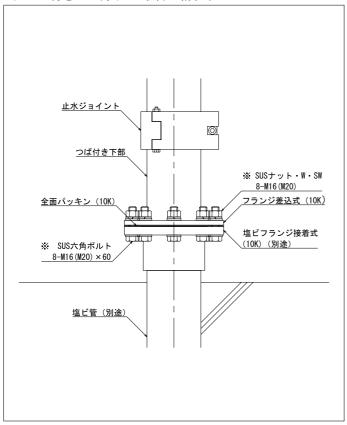
$\times$  89 $\phi \sim 114\phi$  : M16  $140 \phi \sim 165 \phi : M20$
