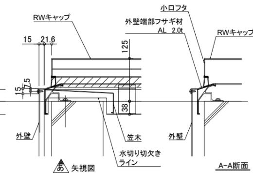
外壁端部フサギ材寸法図
