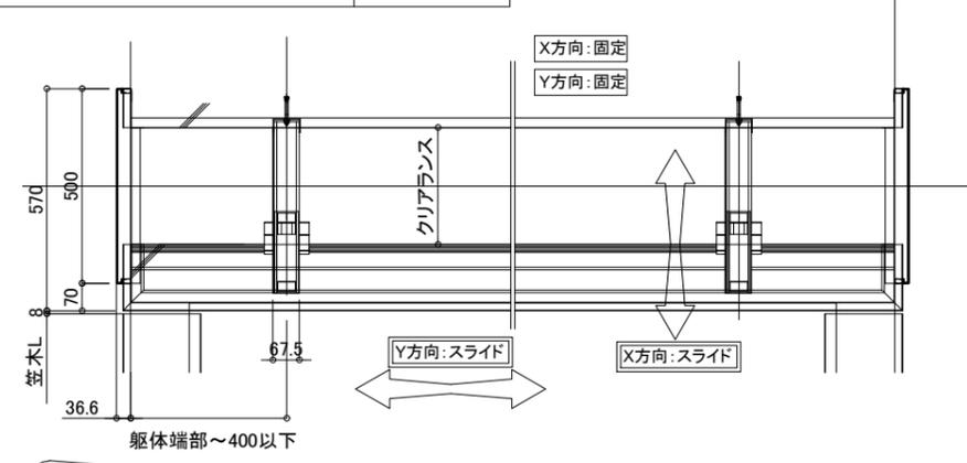
※ステンレス仕様の外壁端部フサギ材は SUS1.5t H. L仕上げ
