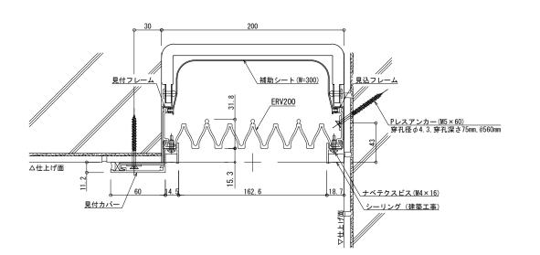
可動図 可動量 + 110mm - 110mm - 110mm - 100mm
