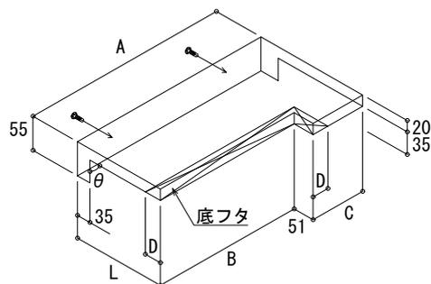
( $L = \text{躯体寸法} + 35\text{mm} \times 2 + 4\text{mm}$ )
