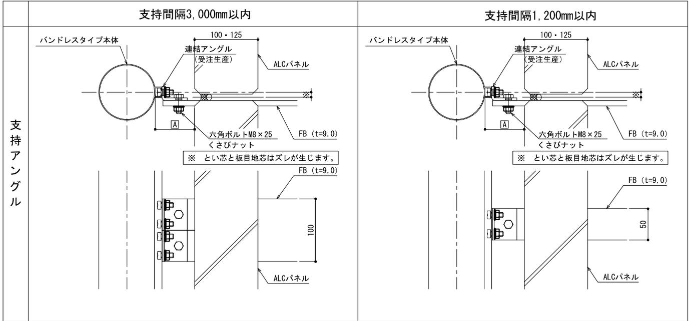
9) 押出成形セメント板への取付け
