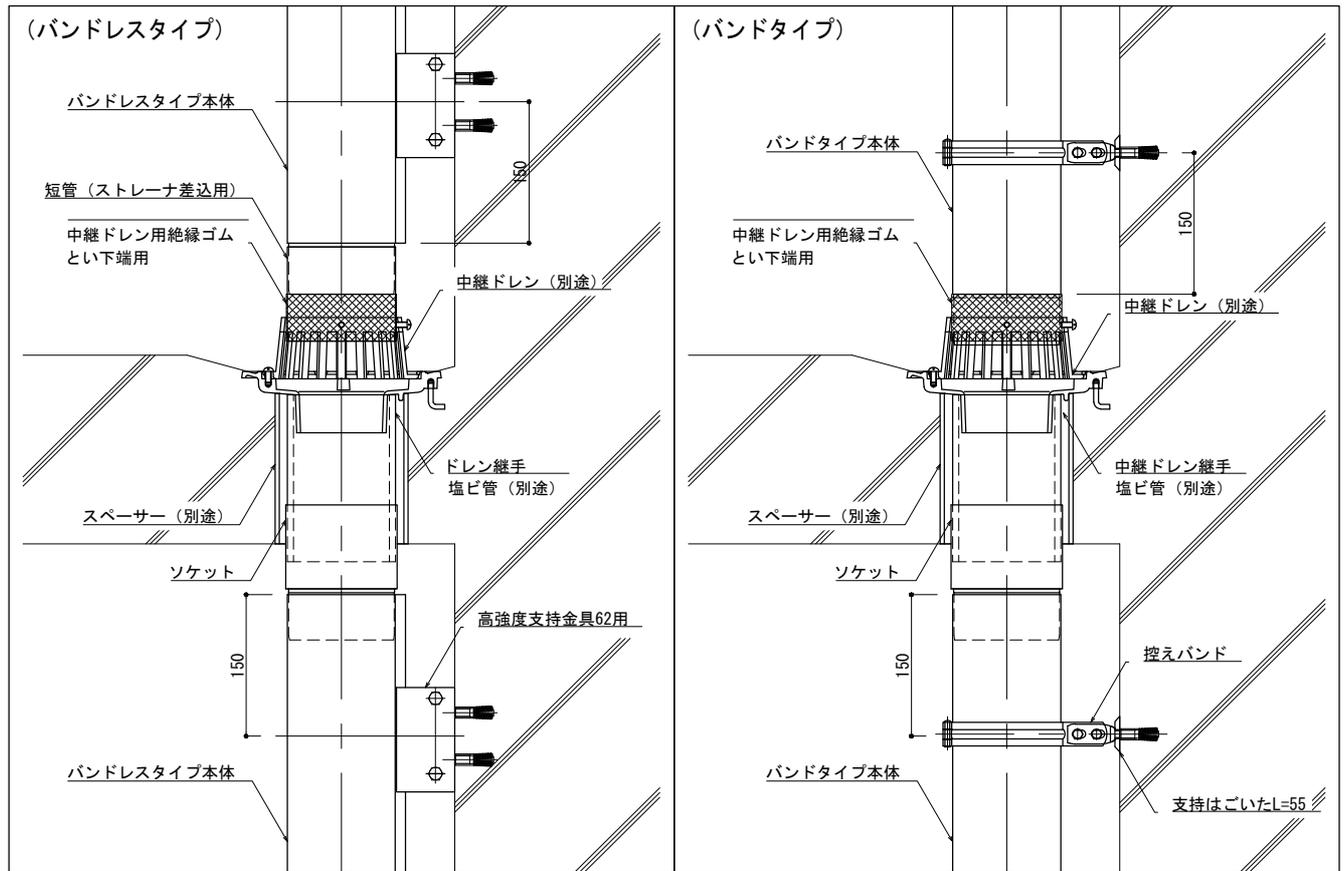
片ネジ式ドレン継手 納まり (ソケット使用)
