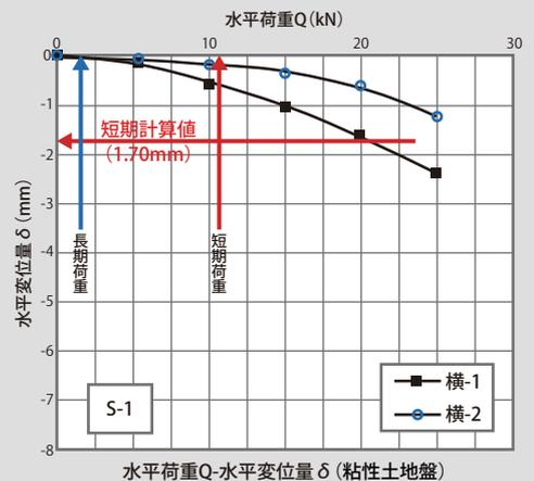
粘性土地盤試験に関しては、現場施工(柱状改良)においては、練混ぜ不足になる事も予測されるため、本試験においては、羽根切り回数を通常より少なくして、あえて練混ぜ不足の状態にて試験を行っています。
