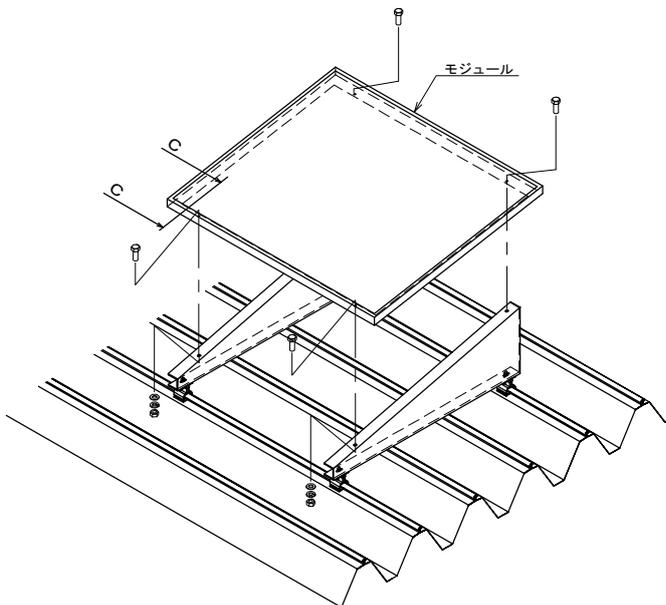
③モジュールの取付モジュール裏面取付穴に六角ボルトを差込み支持金具に取り付けます。
