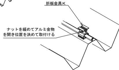
①取付金物の取付所定の間隔で折板金具Kを折板に取付けます。
