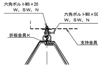
②支持金具の取付支持金具を折板金具Kに固定します。
