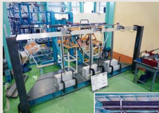
水平荷重試験（後付工法2940N/m）
